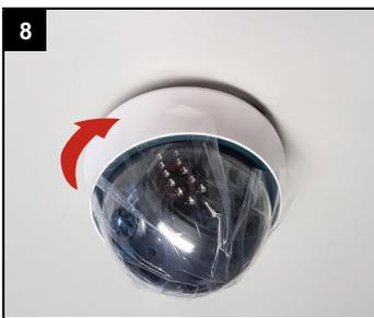
Setzen Sie die Haube wieder auf die Kamera und drehen Sie die Haube in Pfeilrichtung, bis sie einrastet. Ziehen Sie die Schutzfolie ab.
